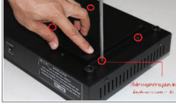
รูปแสดง การวางและตำแหน่งจุดขันน็อตที่ฝาครอบแบตเตอรี่
