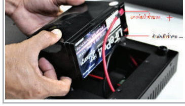
รูปแสดง ลักษณะการติดตั้งแบตเตอรี่ลงในแท่นและต้องสายชาร์จไม่ให้ขยับ
